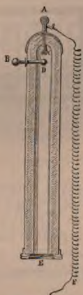
Fig. 28. Eudiomètre ordinaire. Détermination, par synthèse, de la composition quantitative de l'eau.
